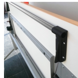
Déclenchement de la fonction de pliage au moyen d'une commande de sécurité à deux mains
